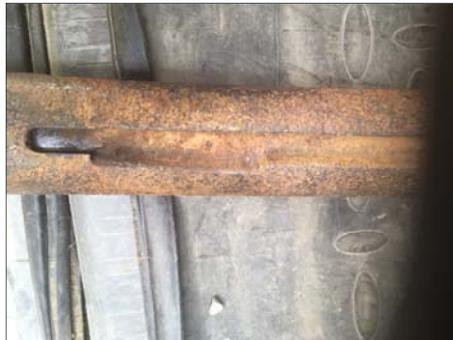
*Constataion des dégâts sur l'axe et la rainure d'accouplement*
