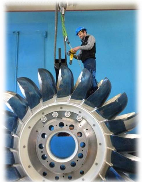
**Projet NOROUE :** réception et montage de la nouvelle roue Pelton destinée à l'usine de Pallazuit.
