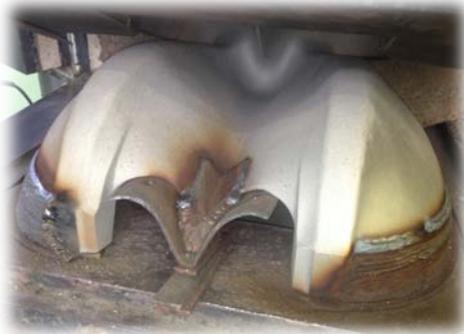
**Projet RENOROUÉ5 :** Les travaux de recharge de la roue Pelton N° 5 sont terminés ; celle-ci est actuellement en usinage du nouveau profil.
